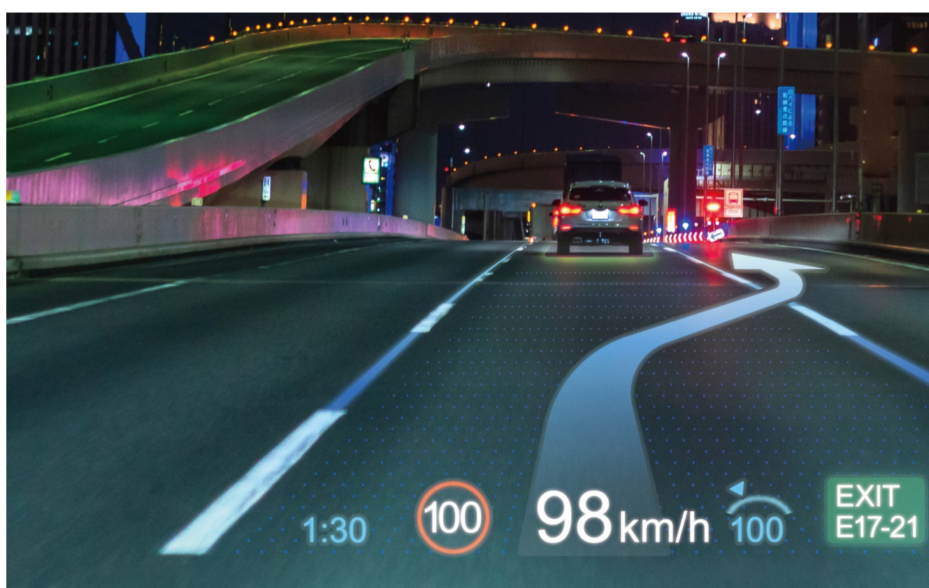
車のフロントガラスに速度などの情報を投映 = 日本精機提供
