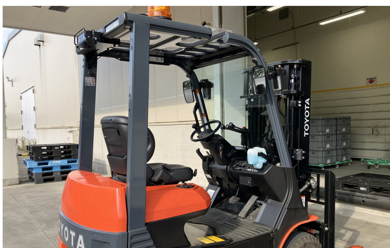
オプトルのステレオカメラがフォークリフトの上部後方に設置されている
