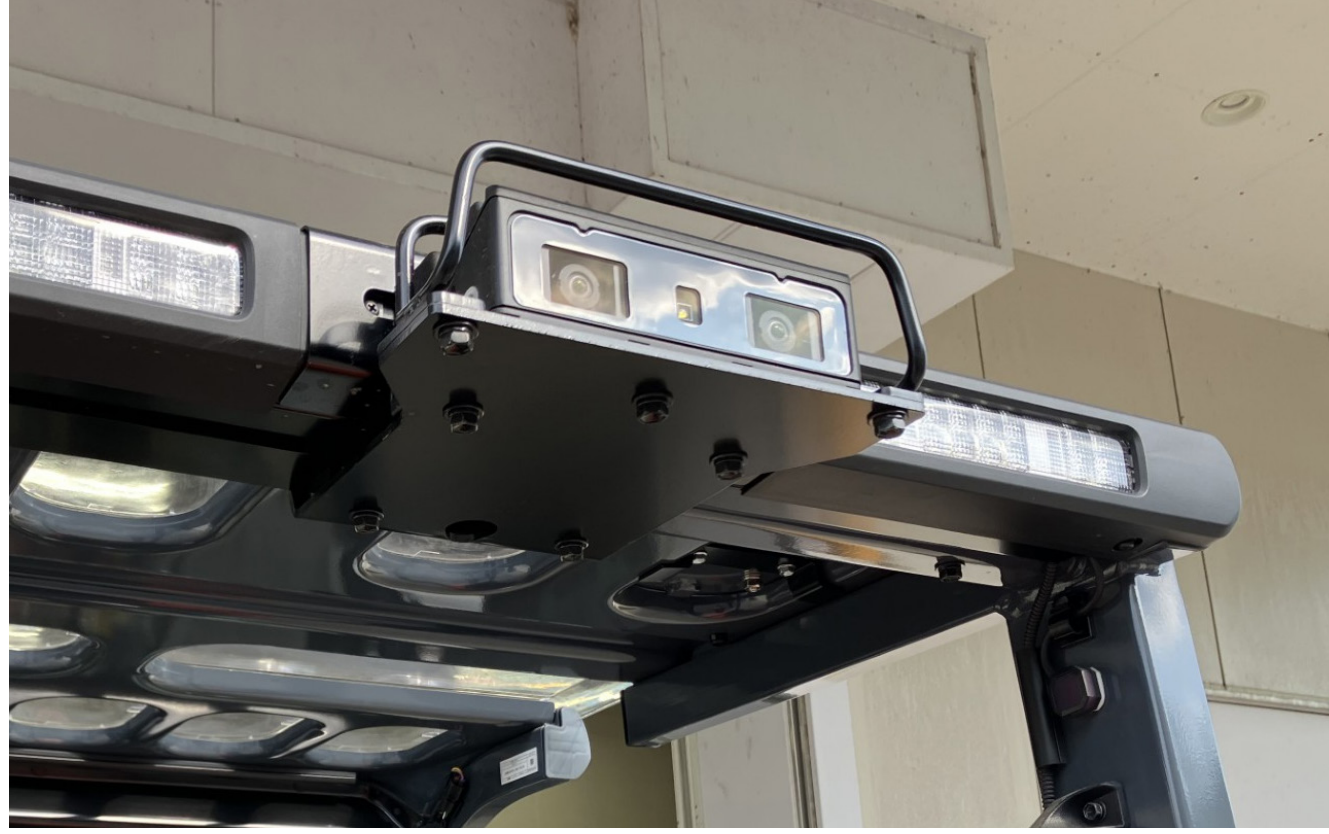
フォークリフト上部後方に設置されたオプトルの産業用ステレオカメラ
