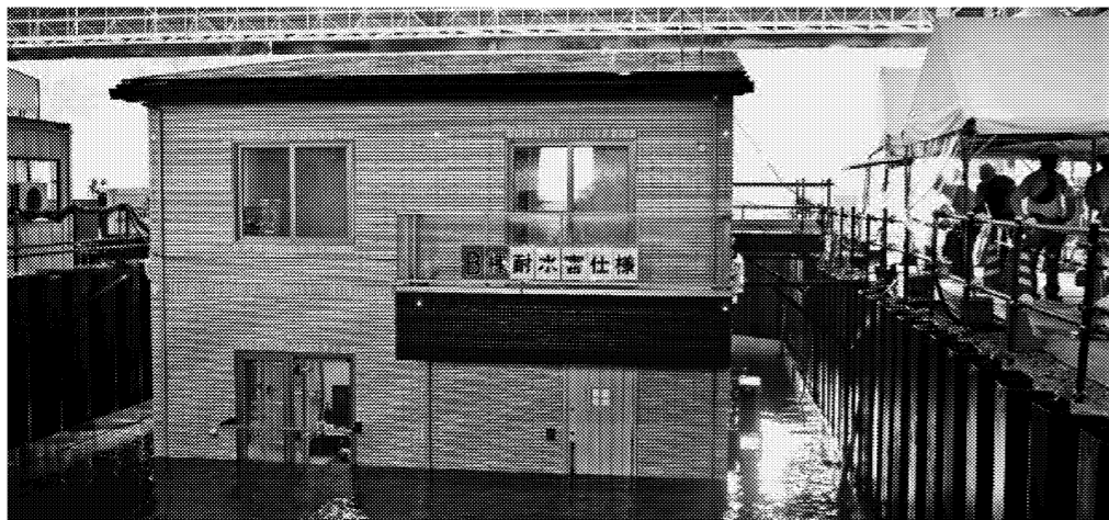
一条工務店は水位が腰まで上昇しても浸水を防ぐ住宅の公開実験を実施した(19年10月、茨城県つくば市)
