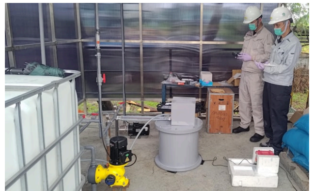
24年12月、工場内の水処理に信大クリスタルを用いる実証実験を行った（インドネシア・ジャカルタ郊外）
