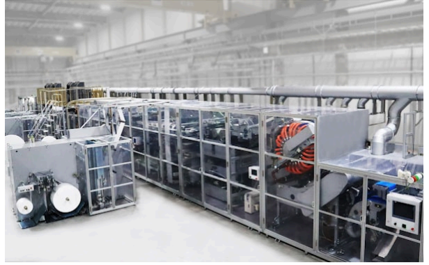
瑞光のオムツ製造装置。毎分最大1000枚生産できる
