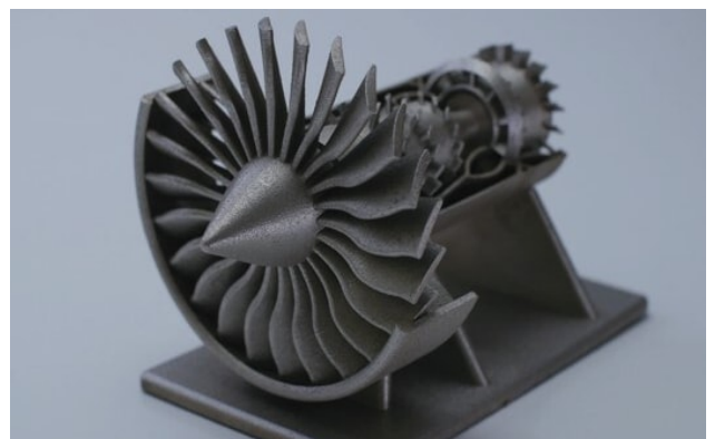
日本 Casting がTNCMを使い金属3Dプリンターでつくる部品の試作モデル
