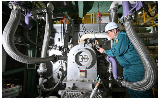
アンモニアを燃料とする工業炉用のバーナーを開発する中外炉工業の試験プラント（2月、堺市）
