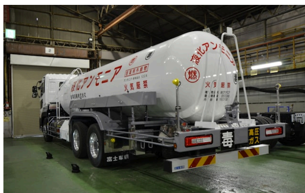
富士車両が開発生産するアンモニア運搬用のタンクローリー
