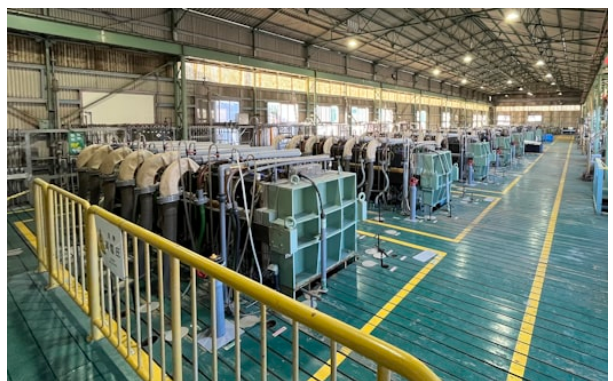
イオン交換膜の透析槽＝日本海水提供
