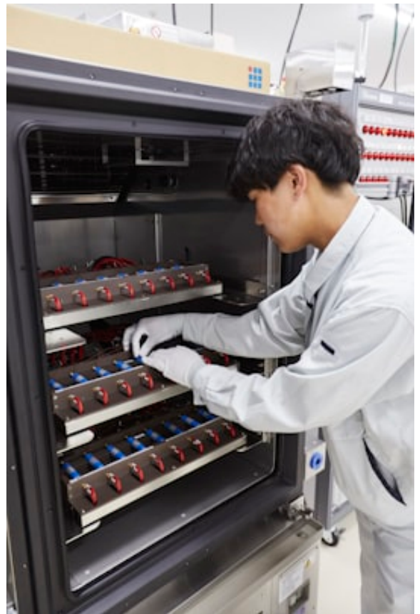
専用の装置内で充放電を繰り返し、電池の性能や耐久性を調べる
