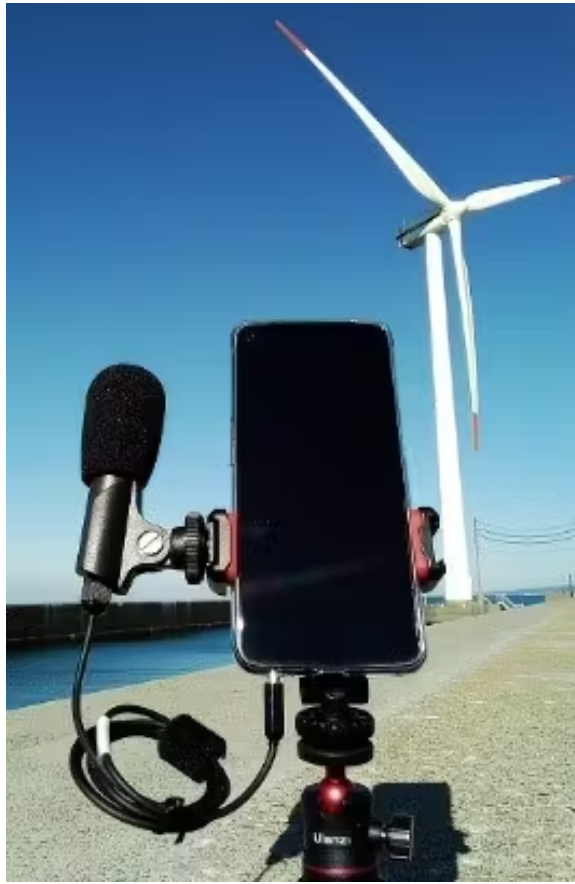
発電用風車のそばにスマホを置き、発生音を測定する
