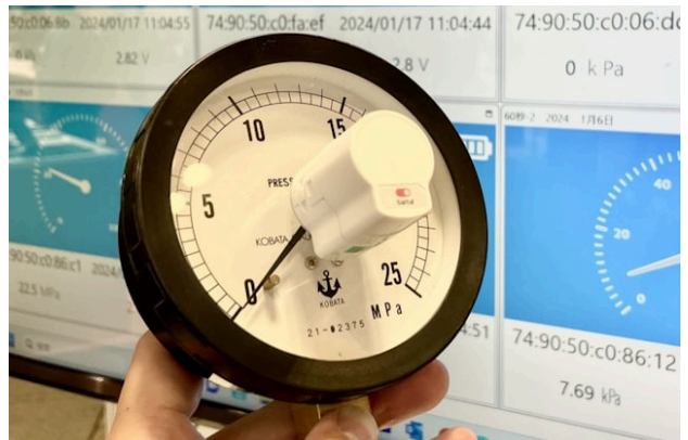
木幡計器のセンサー「サルタ」（ガラス板中央の円筒部分）は既存の圧力計に後付けできる
