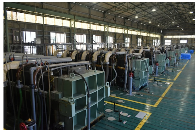
日本海水は「イオン交換膜製塩法」で年間約20万トンを製塩、2023年には累計生産量が1000万トンを突破した
