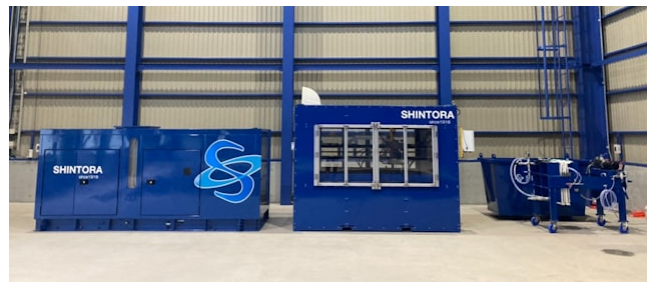
左から水流ポンプ、パネル解体、水ろ過の各装置。大型トラックに一式を積んで運搬できる
