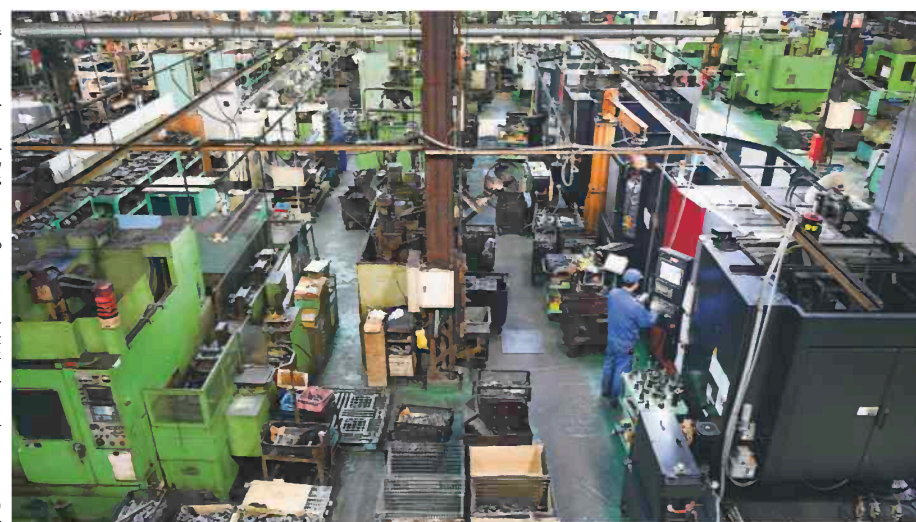
スーパーツールは金属を自動的に加工するマシニングセンターを導入し、効率よく工具や部品を生産する(堺市)
